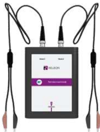
Рис. 1. Двухканальная приставка-осциллограф Releon
