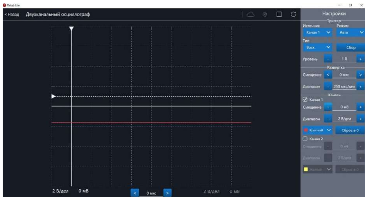
Рис. 40. Сигнал с ненулевым смещением
