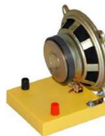
Рис. 2. Динамик низкочастотный на подставке
