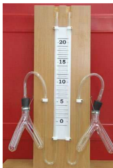
Рис. 19. Прибор для определения скорости химических реакций
